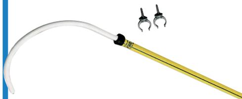
Die Rettungsstange für Arbeiten an stromschlaggefährdeten Orten besteht aus GFK-verstärktem Polyester. Damit lässt sich das Opfer eines Bogenüberschlags an der Hüfte aus dem Gefahrenbereich ziehen. Länge der Stange: 1,5 m
