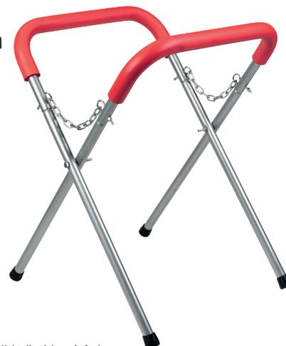
Es ist äußerst robust und ermöglicht die sichere Aufnahme aller Arten von VL- und LKW-Windschutzscheiben zur Vorbereitung für die Montage. Es besteht aus Stahlrohren, die mit flexiblen Anti-Rutsch-Manschetten ummantelt sind, die ein Verrutschen und Kratzer verhindern. Er ist beweglich und verstellbar, lässt sich leicht verstauen und problemlos in der Nähe des Arbeitsplatzes platzieren.
